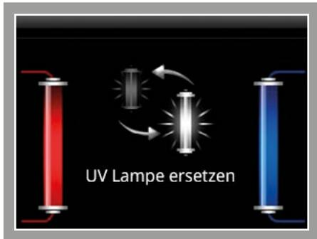
Die UV-Filterlampe muss alle zwölf Monate ausgetauscht werden. Die Anzeige von BIBO weist Sie darauf hin, wenn sie ausgetauscht werden muss. Wenn ein Austausch fällig ist, wird diese Meldung angezeigt:
