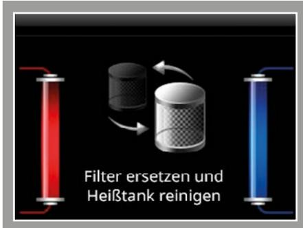
Die Kartusche des MAXI-Filters des BIBO muss alle sechs Monate ausgetauscht werden. Die Anzeige des BIBO weist Sie darauf hin, wenn der Filter ausgetauscht werden muss. Wenn ein Austausch fällig ist, wird diese Meldung angezeigt:
