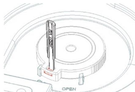
An der Vorderseite Ihres BIBO sieht man den weißen Aufsatz der UV-Filterlampe. Nehmen Sie den mit Ihrer neuen UV-Lampe bereitgestellten kleinen, weißen Plastikschlüssel zur Hand. Stecken Sie den Schlüssel wie unten zu sehen in die Öffnung, hebeln Sie den Riegel mithilfe des roten Streifens nach vorne auf und drehen Sie die UV-Lampe gegen den Uhrzeigersinn in die Position „OPEN“. Ziehen Sie die UV-Lampe nach oben aus dem BIBO heraus.
