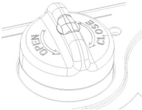
OPEN - Fest gegen den Uhrzeigersinn drehen, um den benutzten Filter zu entfernen.
