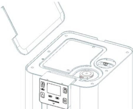
Entfernen Sie den Deckel an der Oberseite des BIBO, indem Sie ihn einfach abheben. Am besten hebt man den Deckel zuerst hinten an.
