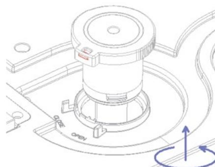
Nehmen Sie die neue UV-Lampe aus ihrer Verpackung und setzen Sie sie vorsichtig ein. Drehen Sie sie dann im Uhrzeigersinn in die Position „CLOSE“, es klickt und sie rastet ein.
