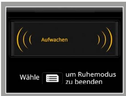
Drücken Sie [Menu Icon] drei Mal, um zu bestätigen, dass Sie das Gerät einschalten möchten. Beim erneuten Einschalten des BIBO nach dem Ein-/Ausschaltmodus benötigt der Heißwassertank etwa fünf Minuten, um wieder die höchste Temperatur zu erreichen. Der Kaltwassertank benötigt etwa 15 Minuten, um wieder die niedrigste Temperatur zu erreichen.
