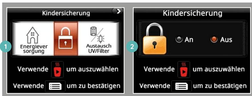
Nach Einstellung der Kindersicherung wird nur heißes Wasser ausgegeben, wenn man [Hot Water Icon] drückt und danach länger als drei Sekunden die Schaltfläche [On/Off Icon].
